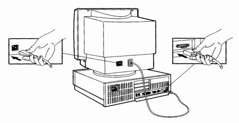
Der Bildschirm ist für den Betrieb mit allen Netzsystemen geeignet, einschließlich IT-Netzsystemen. Um die Stromzufuhr vollständig zu unterbrechen, müssen Sie das Netzkabel aus der Netzsteckdose ziehen, deshalb sollte der Bildschirm in der Nähe einer leicht zugänglichen Netzsteckdose positioniert werden.
