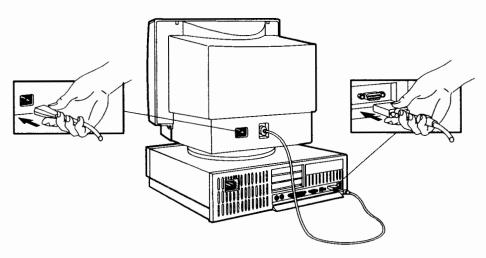
Il video è stato realizzato per funzionare con tutti i sistemi di alimentazione, compresi i sistemi "IT". Per interrompere l'alimentazione, occorre staccare l'apposito cavo dalla presa di corrente. Si consiglia quindi di posizionare il video in prossimità di una presa facilmente accessibile.
