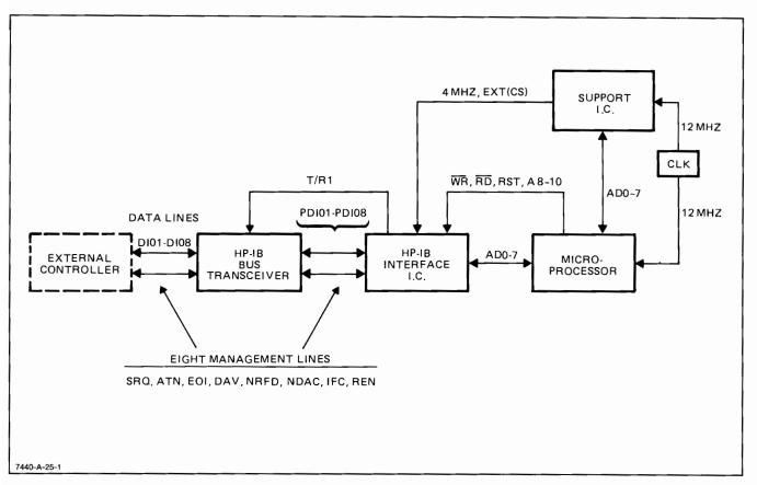
Figure 5-10. HP-IB Block Diagram
