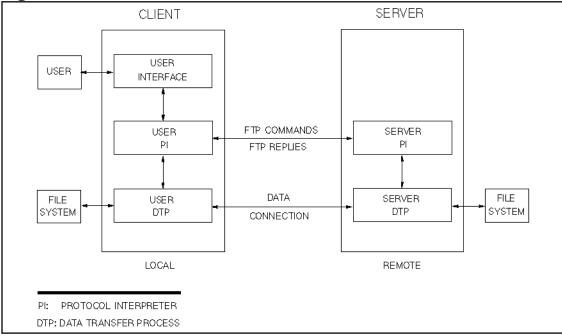
Figure 1-1. FTP Client-Server Model
