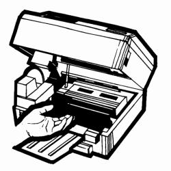
2. Open fusing assembly cover Deckel des Fixierelements öffnen Soulever le couvercle de l'unité de fusion Abra la cubierta de unión Sollevare il coperchio del gruppo di fusione Open deksel inbrandeenheid Åpne lokket på smelteenheten Dækslet til fikseringsenheden åbnes Öppna locket till säkringarna Avaa sulakesarjan kansi
