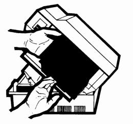
11. Install EP cartridge EP-Kassette einlegen Mettre en place la cartouche EP Instale el cartucho EP Inserire la cartuccia EP Plaats EP-patroon Legg inn skrivepulverkassetten Installer EP-kassetten Sätt in färgkassetten Asenna EP-kasetti
