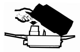
5. Close cover Abdeckung schließen Refermer le couvercle Cierre la cubierta de la impresora Richiudere il coperchio Sluit deksel Lukk dekselet Luk låget Stäng kåpan Sulje kansi
