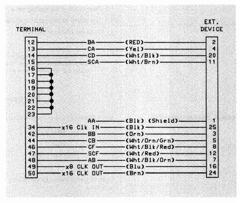
Figure 2-7. 13222C (RS232C) Cable Wiring
